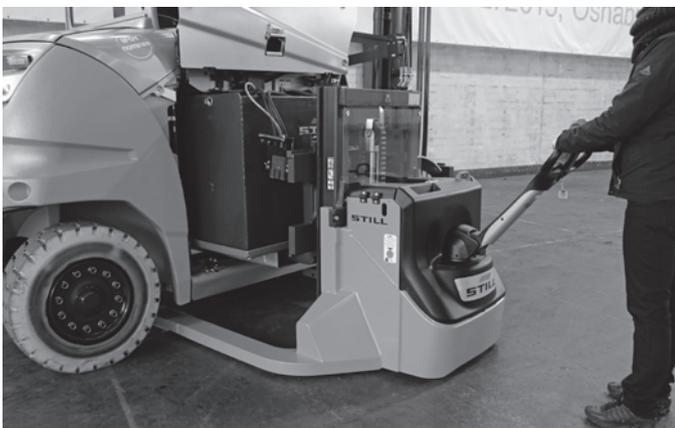
Schneller Batteriewechsel mit dem Hochhubwagen ECU 30
