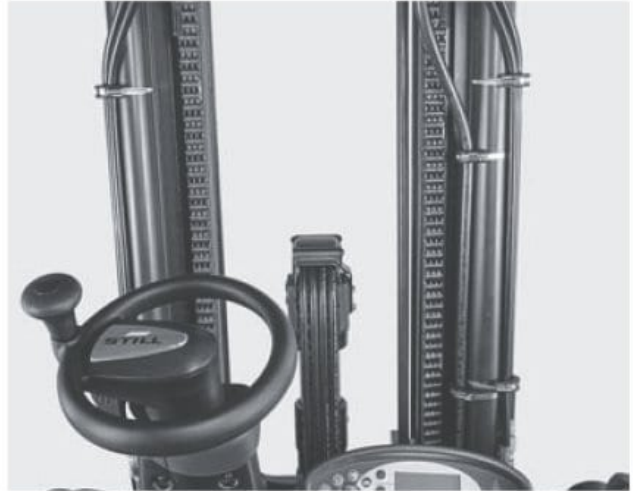
Freie Durchsicht beim Dreifach-Hubgerüst
