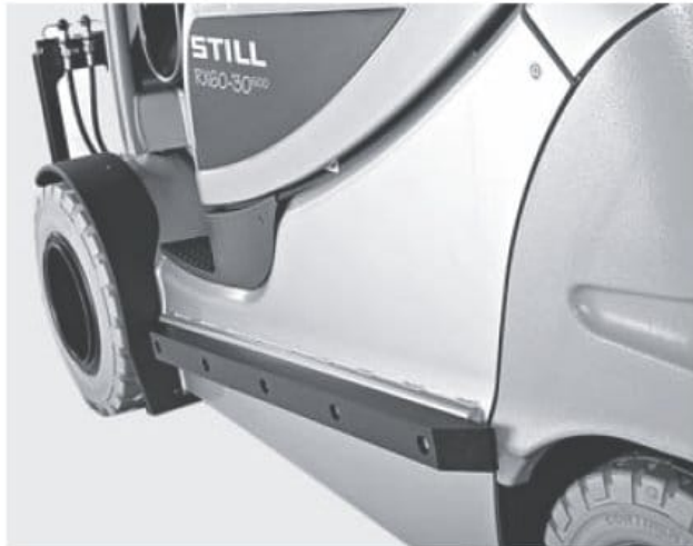
Seitenschutz für besonders harte Einsätze
