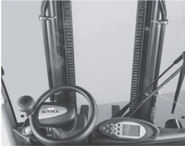
Freie Durchsicht beim Tele-Hubgerüst
