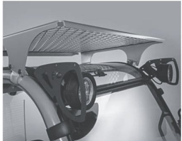
Zusatzschutz gegen fallende Lastteile
